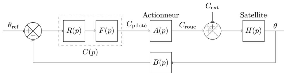
**Figure 11** Schéma-bloc de la boucle d'asservissement d'attitude
