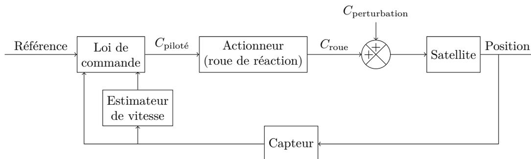
**Figure 10** Architecture du système SCAO
